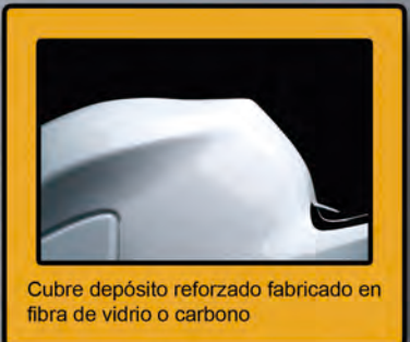
Excelente terminación gel coat blanco que evita la necesidad de pintar los carenados si no se desea. Tornillería rápida DZUS incluida e instalada
